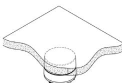
1. Verwenden Sie die Montageschablone, um die Befestigungslöcher an der gewünschten Position zu bohren.
