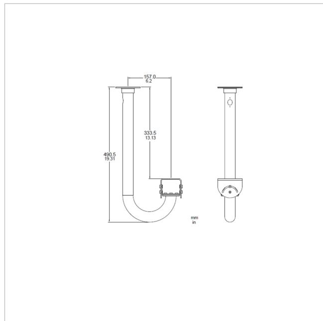
Adapter für Deckenmontage für HSG, UHI, UHO-Gehäuse
