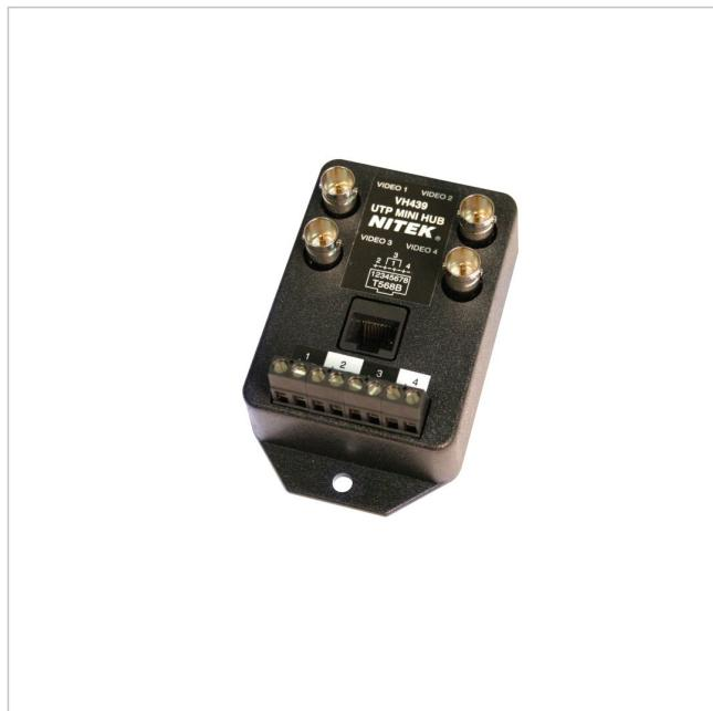
Passiver 4-Kanal Video Zweidrahtsender BNC-Eingänge
