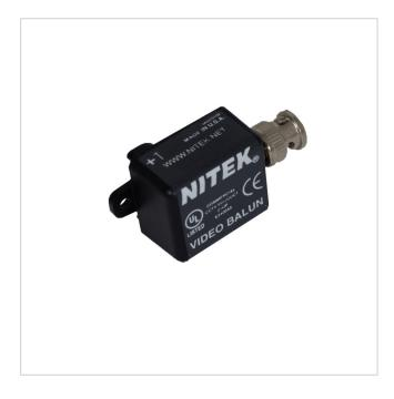
Passiver Zweidraht-Sender oder Empfänger mit FBAS/BNC-Stecker Ein/Ausgang
