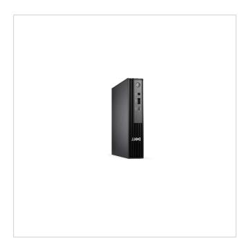
DPM Workstation, Intel Core i3 14100T 8GB (1x8GB, DDR5 bis 4800MT/s, non-ECC) Keine GPU
