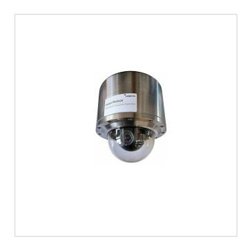
Netzwerk PTRZ Domekamera im Edelstahlgehäuse gemäß RL 2014/34/EU (ATEX), IECEx und EAC-Ex, 3840x2160, IP68, -50°C bis +50°C
