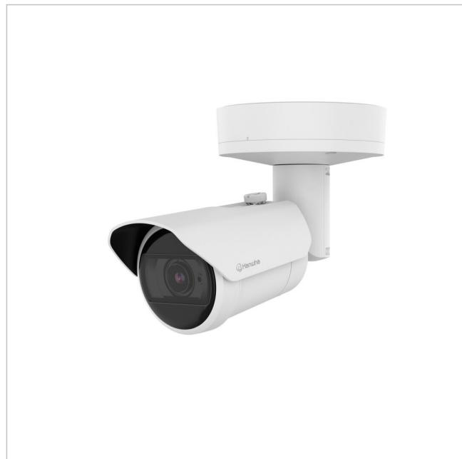
1/2,8" Netzwerk Bullet Kamera, Fix, Tag/Nacht, 2560x1920, Objektiv 3,3-9,3mm, H.265, WDR, IR, PoE, IK10, IP66/67, NEMA4X
