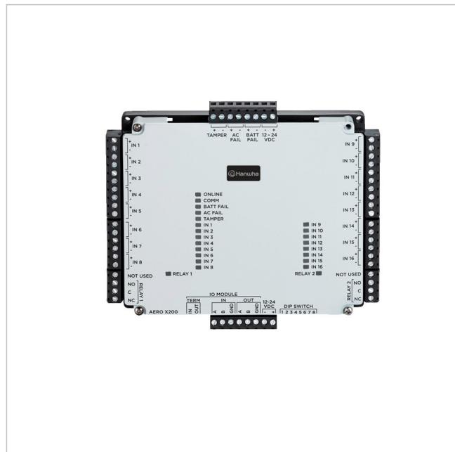
Hanwha-Zugangskontroll-Eingangsmodul, RS485, 12/24 VDC, 16 AUX-Eingänge, Manipulation AC Fail & Battery Fail, 2 FORM-C-Relaisausgänge
