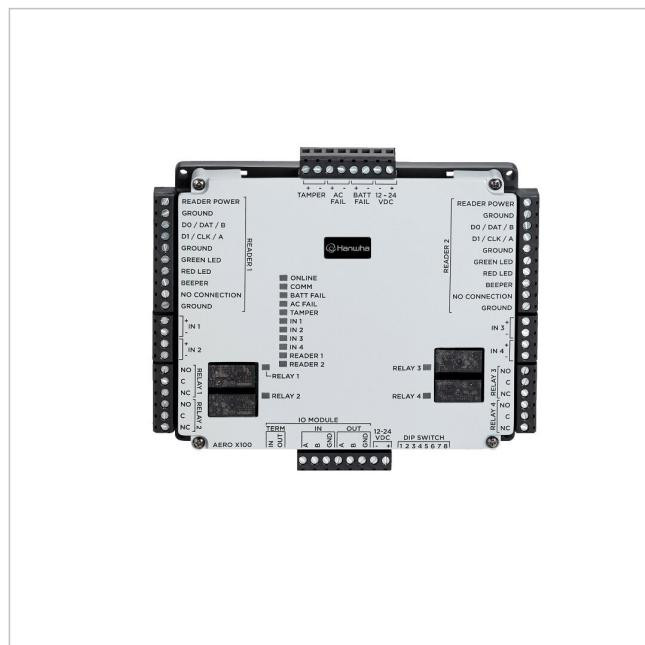
Hanwha Access Control Expansion Board 2-Tür-Controller, 12/24vdc 2-Tür-Controller, RS485 unterstützt 4 OSDP oder 2 Wiegand-Leser, 7 Eing.
