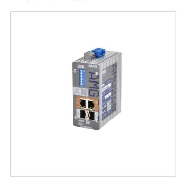
Industrieller PoE Medienkonverter, 2 x 10/100/1000BT RJ45 mit 30W PoE, 2 x 100/1000 Base-FX SFP Slot, DIN Rail / Wandmontage
