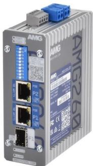
Industrieller PoE Medienkonverter, 2 x 10/100/1000BT RJ45 mit 60/90W PoE, 1 x 100/1000Base-FX SFP Slot, DIN Rail / Wandmontage
