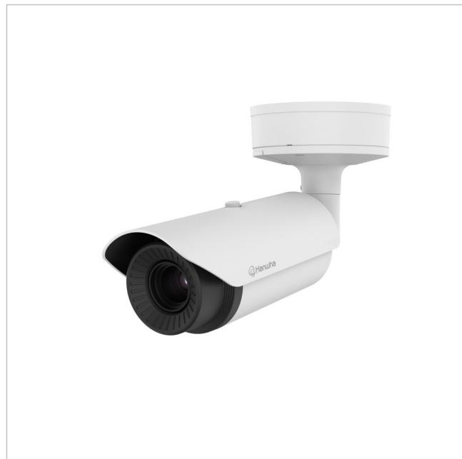
Wärmebild Netzwerk Kamera, Radiometrie, 19mm, 32°, 640x480, 8fps. Audio, IP66, 12VDC, 24VAC, PoE
