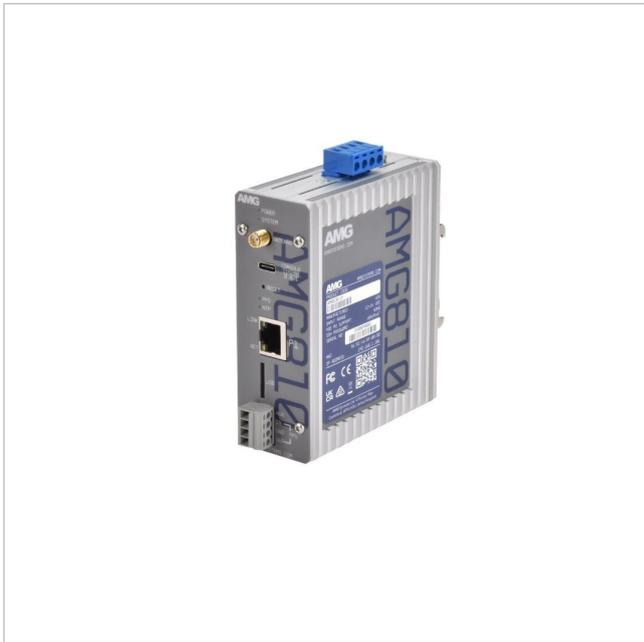
Stratum 1 Netzwerk-Zeitserver 1 x 10/100Base-T(x) RJ45 Port, 1 x GNSS Input, 1 x PPS Input/Output, 1 x Digital Output
