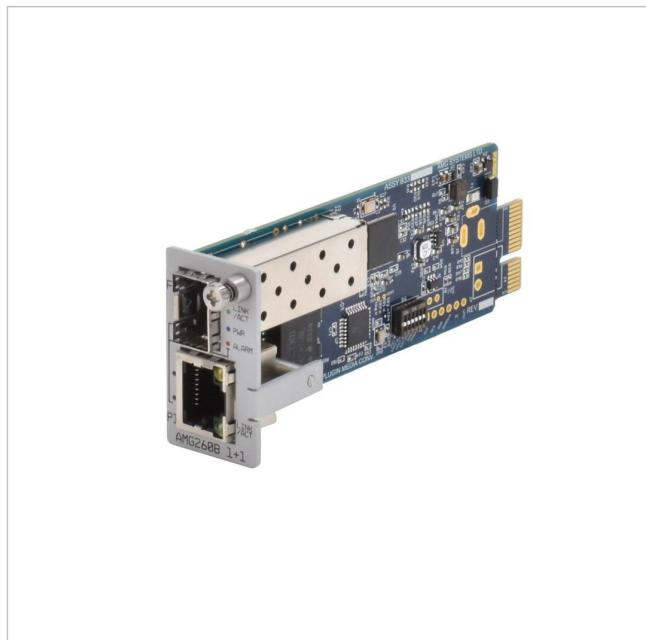
Industrieller Blade Medienkonverter Karte, 1 x 10/100BT RJ45 , 1 x 100/1000FX SFP Slot, ohne SFP, DIP Switch, Blade Halterung 1 Slot
