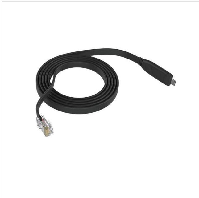
Speziell für Axis D8308, zur Konfiguration
