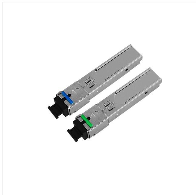
SFP Modul-Päckchen, 1,25Gbps, 20KM Reichweite, Simplex SC, Tx/Rx bei 1310/1550nm, Hot-Plug, SFP MSA-konform, Digital Monitoring integriert
