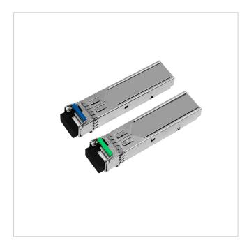
SFP Modul-Pärchen, 1,25Gbps, 3KM Reichweite, Simplex LC, Tx/Rx bei 1310/1550nm, Hot-Plug, SFP MSA-konform, Digital Monitoring integriert
