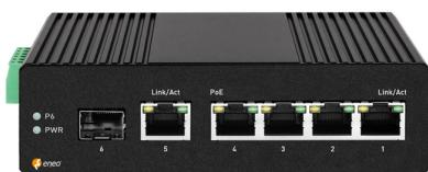
Gigabit Switch Industrie, Unmanaged, 4x PoE, 1xRJ45, 1xSFP, max 30W pro Port, -40°C~75°C, 44~57 VDC, ohne Netzteil
