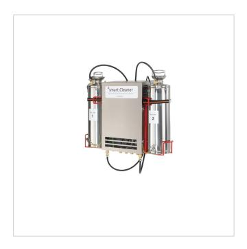
Netzwerkgesteuerte Wischwasserversorgungseinheit, RL 2014/34/EU (ATEX), IECEx, 24VDC, 37W, Max Wasserdruck: 3,5bar, Förderhöhe 20m
