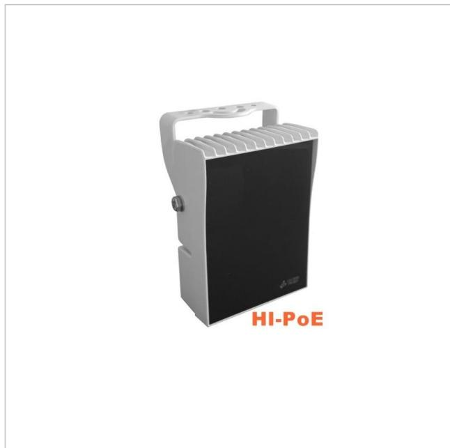
LED Infrarot Scheinwerfer, 850nm, PoE (802.3at), 10° Leuchtwinkel, 240m Reichweite, IP67, 38W
