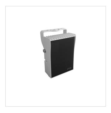
LED Infrarot Scheinwerfer, 850nm, 230VAC/110VAC, 30° Leuchtwinkel, 130m Reichweite, IP67, 18W
