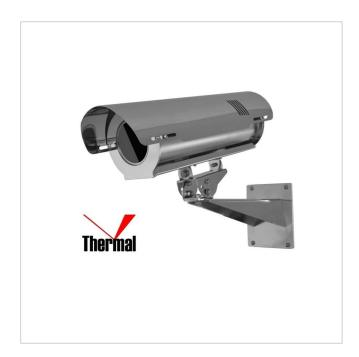
Wetterschutzgehäuse aus Edelstahl, inklusive Sonnendach, 24VAC Heizung, IP66, Thermalglas  $\varnothing$  35mm, Wandhalterung
