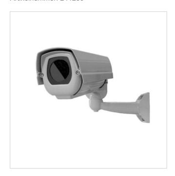
Wetterschutzgehäuse aus Aluminium, inklusive Sonnendach, IP66, Thermalglas Ø 35mm Wandhalterung inklusive, 260mm Nutzlänge
