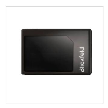
3-dimensionaler Laser Ranging Sensor (LiDAR), Sichtfeld 90 $^{\circ}$  x 50 $^{\circ}$ , Reichweite 85m, Laserklasse 1 IP67, PoE
