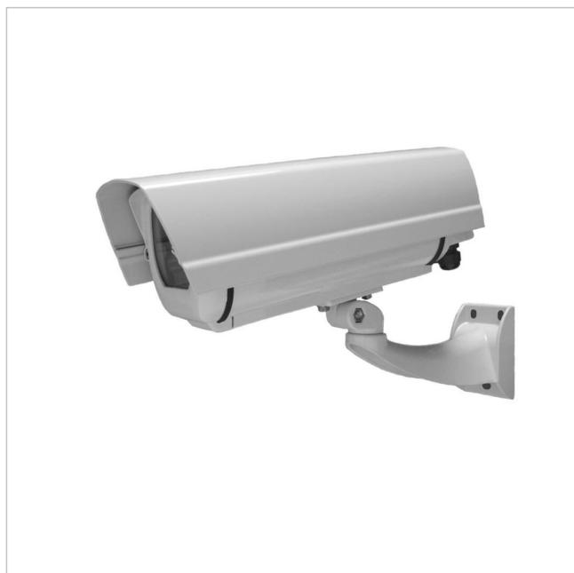
Wetterschutzgehäuse aus Aluminium, inklusive Sonnendach, 24VAC Heizung, IP66, Halterung inklusive, 260mm Nutzlänge
