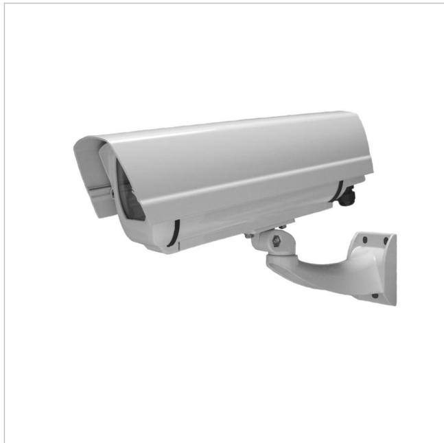
Wetterschutzgehäuse aus Aluminium, inklusive Sonnendach, 12VAC Heizung, IP66, 150mm Nutzfläche
