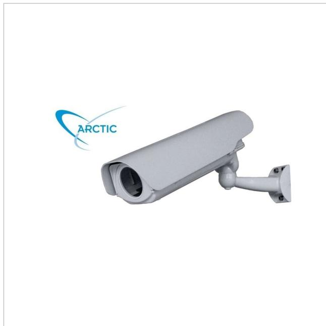
Wetterschutzgehäuse aus Aluminium, inklusive Sonnendach, 230VAC Heizung, IP67, Wandhalterung inklusive, -55° bis +60°C
