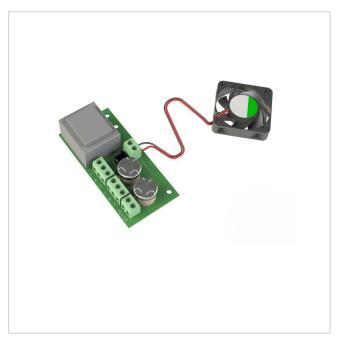
Einbau hochleistungs Lüftersystem für CRONO CPK405
