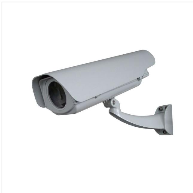
Wetterschutzgehäuse aus Aluminium, inklusive Sonnendach, 230VAC, IP67, eingebauter Wischer, Halterung inklusive
