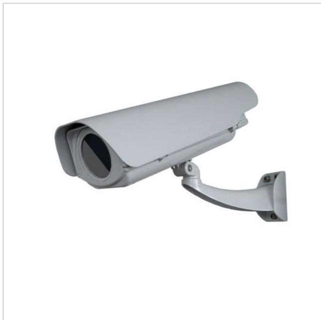
Wetterschutzgehäuse aus Aluminium, inklusive Sonnendach, 230VAC Heizung, IP67, Thermalglas Ø 35mm, Wandhalterung inklusive
