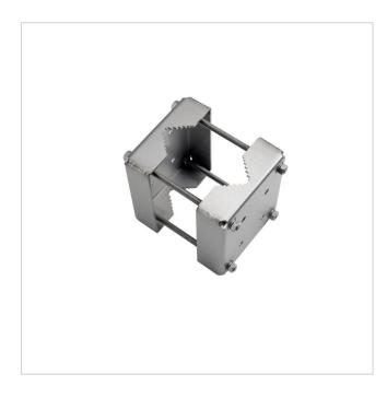
Mastadapter für TNXCD & T08-VA1.x/2.x Wandausleger geeignet für Mastdurchmesser zwischen 100 und 150mm
