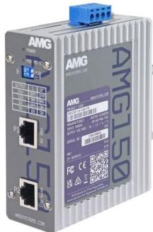
Industrieller PoE Splitter, 1x 10/100/1000BT RJ45 mit 90W PoE PD Input, 1x 10/100/1000BT Port Output, 5/6/12/24 VDC Output @ 60W Max
