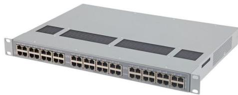
Industrieller PoE-Injektor, 24x 10/100/1000BT RJ45 mit 30W PoE gemäß 802.3at, 720W Max
