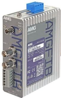
Industrieller 2-Kanal CVI/TVI/AHD/CVBS Video Empfänger, 2x Kontakt in Videorichtung, 1x in Return, Singlemode 20km, 1 Faser, 1550nm
