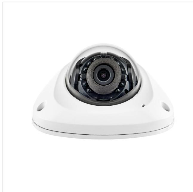
1/2,8" Netzwerk Mini Dome, Fix, Tag/Nacht, 3,6mm, 1920x1080, Infrarot, IP66, IK10, PoE
