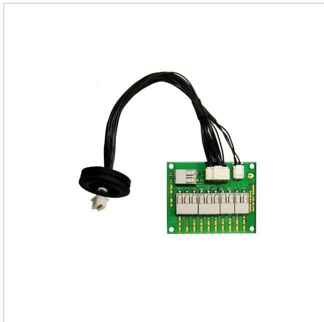
Kabelpeitsche mit 1x Audio Line IN, 1x Audio Line OUT, 2x Kontakt IN, 2x Kontakt OUT, 1x Spannungsversorgung
