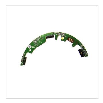
Beleuchtung für DOMERA® Einbaugehäuse, drei IR-LEDs mit insgesamt 180°
