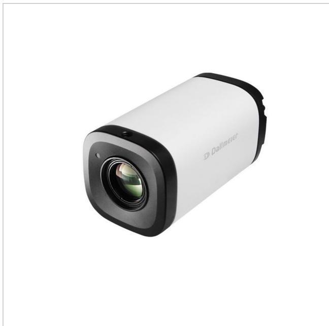
High Definition Kamera, 5 MP, H.265, Tag/Nacht, VCA, WDR/HDR, PoE, Box-Gehäuse, motorgetriebenes Varifokal-Objektiv, F1.8 / 12 – 40 mm
