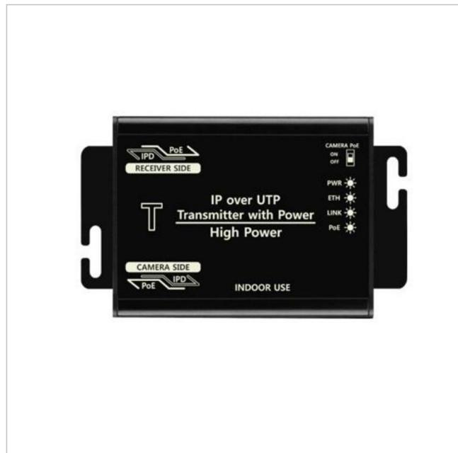
1-Kanal-IP Transmitter, Sender PoE über UTP, High Power (70W) ,Hohe Reichweite bis 800m
