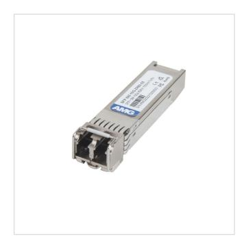
SFP+, 10Gb/s, Doppelfaser, Singlemode, 80km Reichweite Tx/Rx: 1550nm, LC, DDM
