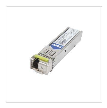
SFP, 2.5Gb/s, Einzelfaser, LC, Singlemode, 20km Reichweite Tx: 1550nm, Rx: 1310nm, DDM
