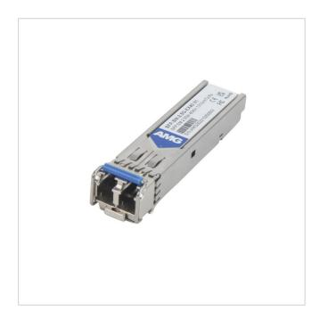
SFP, 2.5Gb/s, Doppelfaser, Singlemode, 40km Reichweite Tx/Rx: 1310nm, LC, DDM
