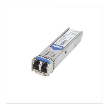
SFP, 2.5Gb/s, Doppelfaser, Singlemode, 20km Reichweite Tx/Rx: 1310nm, LC, DDM
