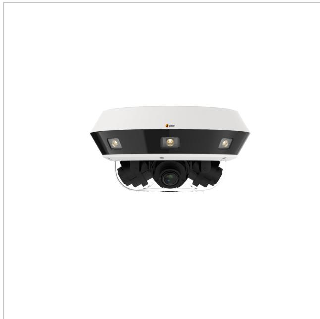
Netzwerk Multisensor Kamera, 360°, 4x 3840x2160, Tag/Nacht, WDR, AI, 4x 2,8-12mm, IR, Weißlicht, IK10, IP67
