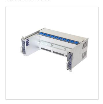
Baugruppenträger für AMG Hutschienengeräte, ausziehbar, 4HE, 19", 1 x 12VDC, 1 x 56VDC
