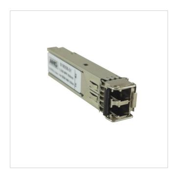
SFP, 1Gb/s, Einfaser, Singlemode, 75km Reichweite (Tx: 1310 nm, Rx: 1550 nm), LC
