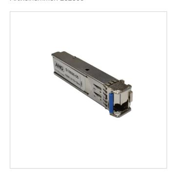
SFP, 100Mb/s, Einfaser, Singlemode, 20km Reichweite, (Tx: 1310 nm, Rx: 1550 nm), LC
