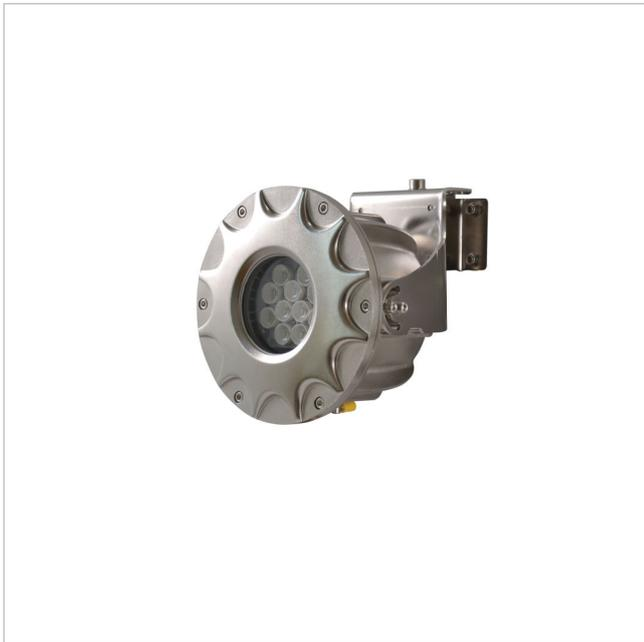
LED Scheinwerfer, IR 850nm, 70 Grad, EX-geschützt, 24VDC/VAC, PoE+
