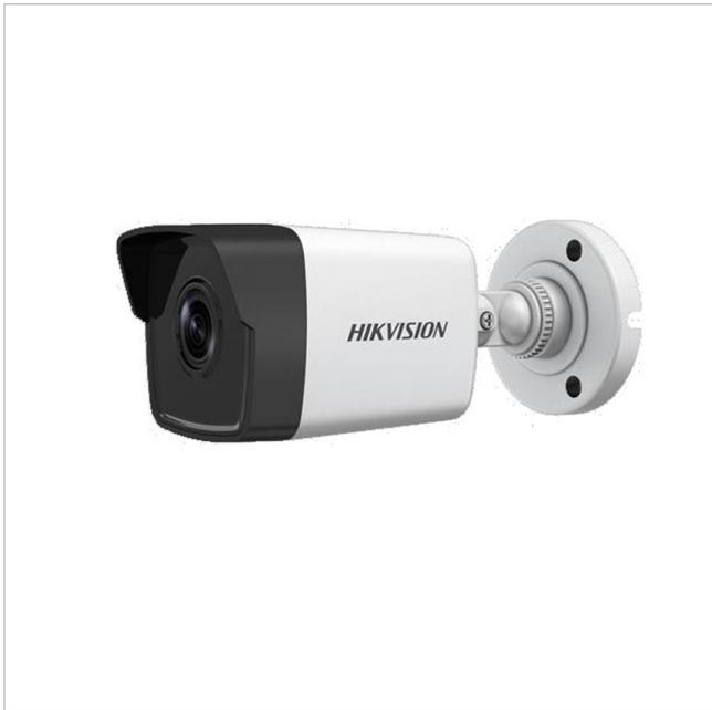
Netzwerk Bullet Kamera, 2,8mm, Tag/Nacht, 2560x1440@20fps, Infrarot, 12V, PoE, IP67
