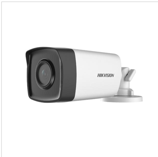
HD Bullet Kamera, Tag/Nacht, 3,6mm, 2MP, Infrarot, 12VDC, IP67
